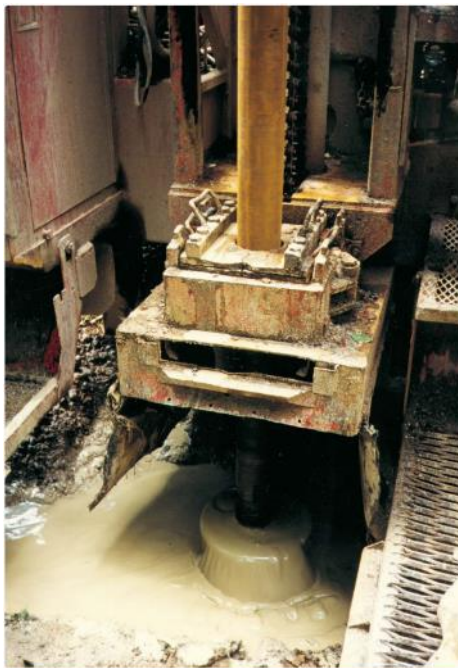
1996: VRTANJE VRTINE ZA RAZISKOVALNI VODNJAK NA SELNIŠKI DOBRAVI
